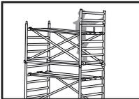
**13** På den översta nivån måste man montera ett komplett skyddsräcke, med två skyddsstag över skyddsramen och två skyddsstag som kopplar samman dessa skyddsramar. Kom ihåg att montera stagen på skyddsräckena korrekt (krokens öppning på utsidan).
