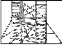
**11** Placera en tillträdesstege för 400 modell om det finns en inbyggd steg på ramen. Montera en plattform på toppen och Repetera steg 10 för varje extra modul. Vissa plattformar och stag kan ändras (Det maximala avståndet mellan plattformar är 4 meter. Alufase rekommenderar 2 meter som maximalt avstånd mellan plattformar).
