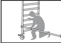
**4** Placera ett horisontalstag på samma höjd på ramens motsatta sida. Om man har en rullställning med dubbel bredd (1,35 m) använder man två horisontalstag istället för ett.
