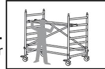
**9** Montera stödbenen. Dessa måste fästas till ställningens alla hörn, i samma rör som benen fästs på. Stabilisatorrörets led måste låsas med vingmuttrarna. Den övre vingmuttern måste placeras precis under en tvärpinne på ramen för att undvika rörelser. Försäkra att den roterande bromsbacken är till 100 % i kontakt med marken.
