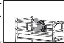
**15** Slutligen, försäkra att ALLA hjulens bromsar är låsta och att stödbenens roterande bromsklossar har markkontakt.
