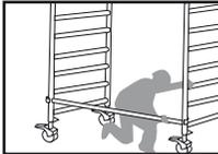
**5** Placera två diagonalstag i kors. Höjdskillnaden från en sida till den andra på diagonalstaget måste vara 4 tvärpinnear (vanligtvis mellan 2:a och 5:e tvärpinne), medan stagen måste placeras så nära de vertikala rören som möjligt på ramen. För rullställningar med dubbel bredd (1,35 m) måste varje ram fixeras med 4 diagonalstag, två på varje sida.
