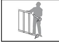
**3** Placera ett horisontalstags krok, så lågt som möjligt, i ett vertikalt rör på ramen och luta stagets andra sida mot marken. Krokens hål måste ha öppningen på utsidan.
