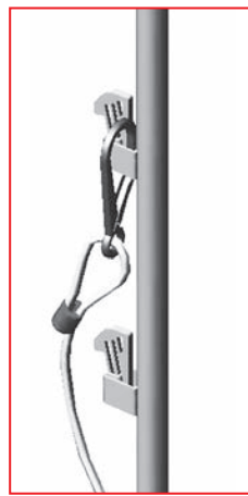
Kuva 3.2 - Kiinnitys rakenteeseen kiinteästi liitettäviin pidikkeisiin
